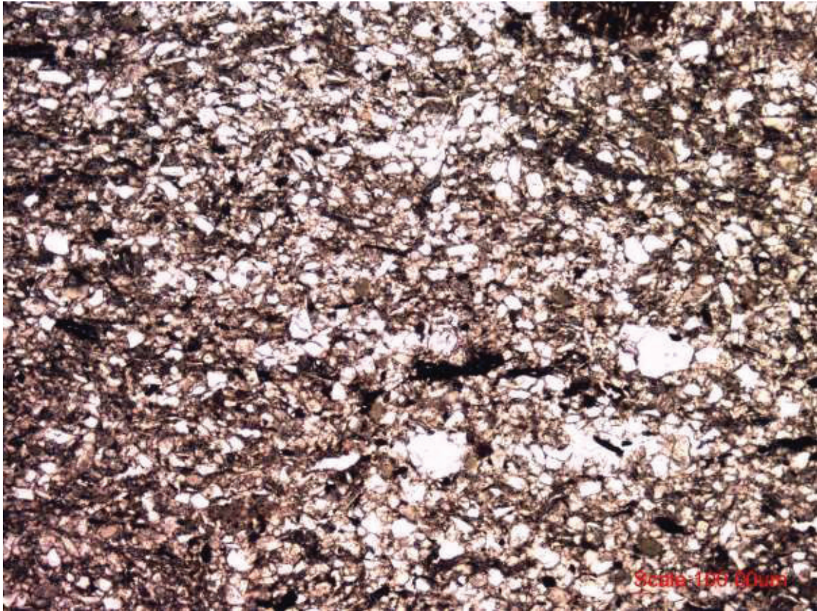
Afb. 78 grondmassa met in-situ verbrande vegetatie dat is afgezet in dunne gefragmenteerde snoertjes (30x vergroot, PPL)
