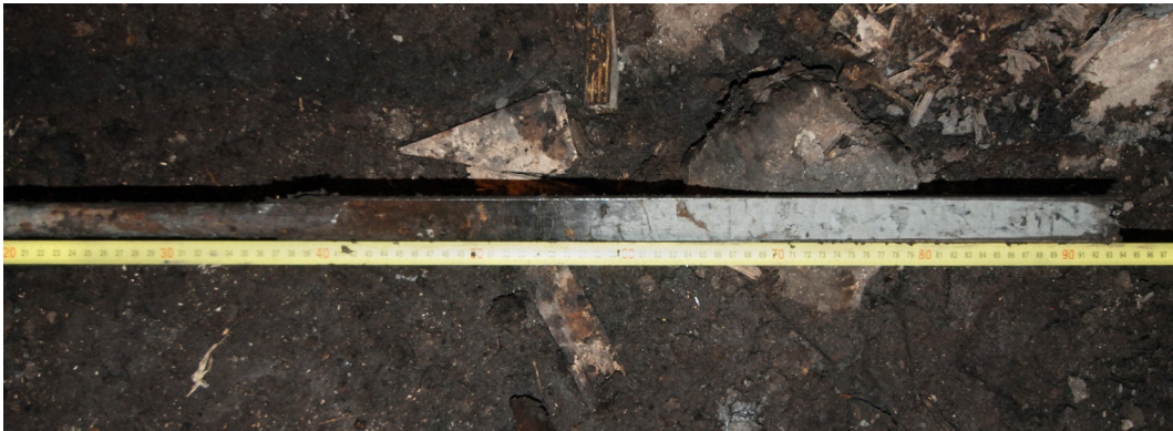
22 Overgang van bruine venige klei (S 86) via de dunne geoxideerde toplaag (S 89) naar de licht grijze zandige wadafzetting (S 90, Laagpakket van Wormer) in de guts bij boring 2
