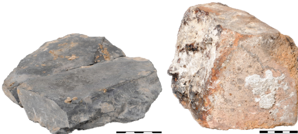
34 Links een fragment van een marver, het hardstenen werkblad van een glasoven (RO21-5-231). Rechts een fragment van de ovenkoepel (RO21-40-1) uit de ophoging (S 6) rond het luchtkanaal
