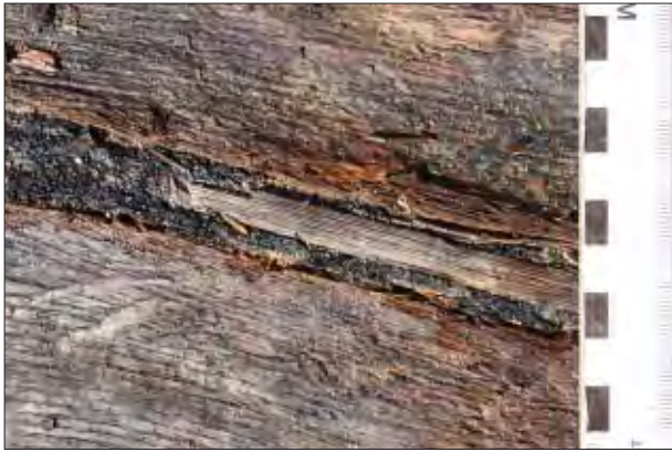
Afb. 16.36 Detail van eiken scheepsplank met breeuwlatje op mos om scheur te dichten (vondstnummer 71) (©BIAX Consult).
