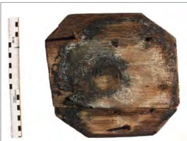
Afb. 16.19 De deksel van fijnspar met teerresten en ijzeren spijkers waarmee het uiteinde van de pompbuis was afgesloten (vondstnummer 176 sub. 2) (©BIAX Consult).
