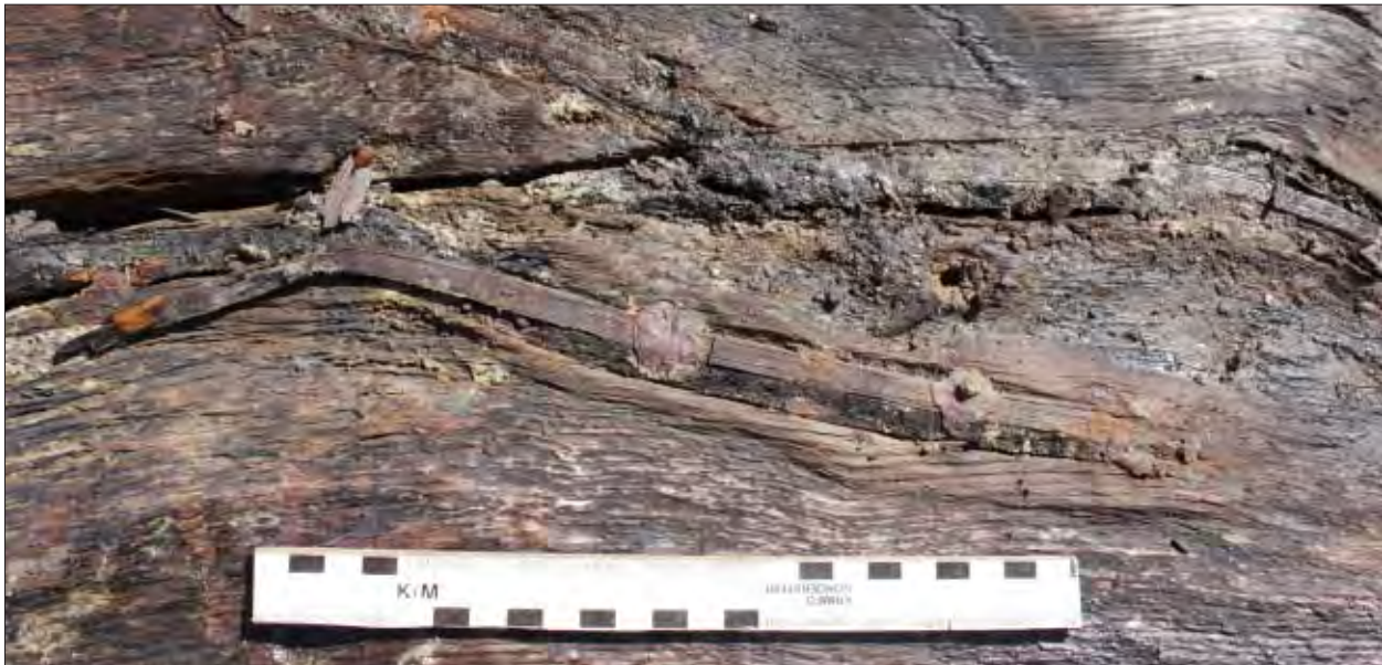
Afb. 16.37 Detail van eiken scheepsplank met vastgespijkerde breeuwlatjes (vondstnummer 71) (©BIAX Consult).
