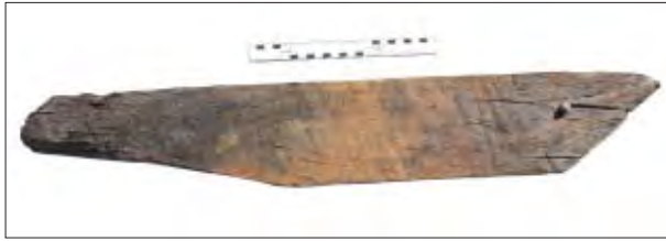
Afb. 16.5 Eikenhouten balk met schuine las en zaagsporen (vondstnummer 123) (©BIAX Consult).
