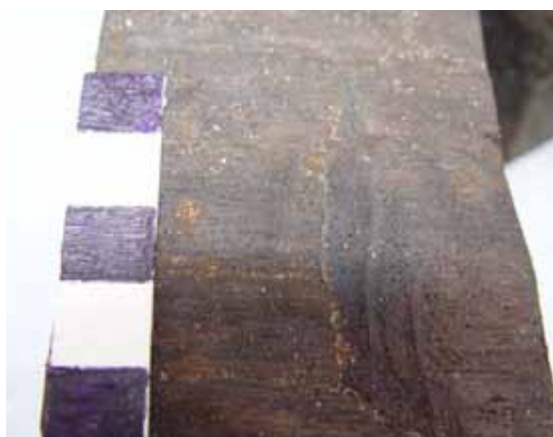
Fig. 18.34 Een schuin kapspoor.
