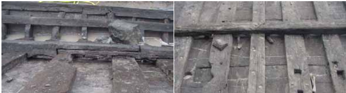
Fig. 18.13 Het in de lengte geplaatste zaathout.
