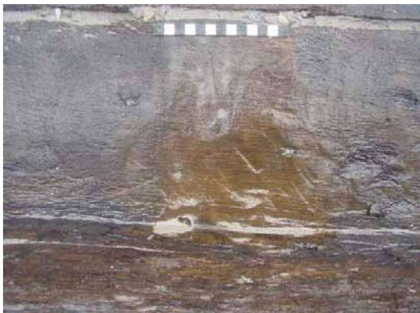
Fig. 18.28 Sporen van een dissel in de kim.
