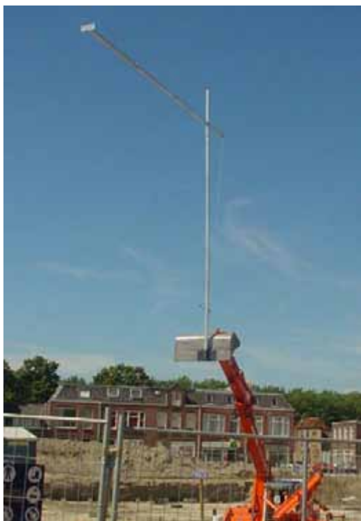
Fig. 3.3 De in Woerden ontwikkelde fothengel (foto: Hazenberg Archeologie Leiden).
