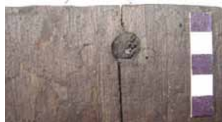
Fig. 18.38 De afdruk van een lepelboor.
