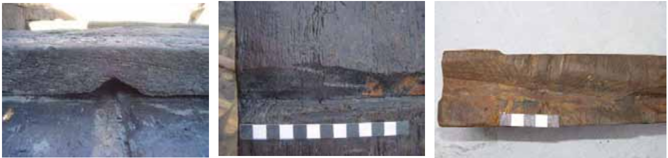
Fig. 18.12 Voorbeelden van met een bijl aangebrachte loggaten.
