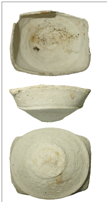
Afb. 28: Uitgeharte mortellaag dat is losgekomen uit een witbakkende test (w-tes-6).
