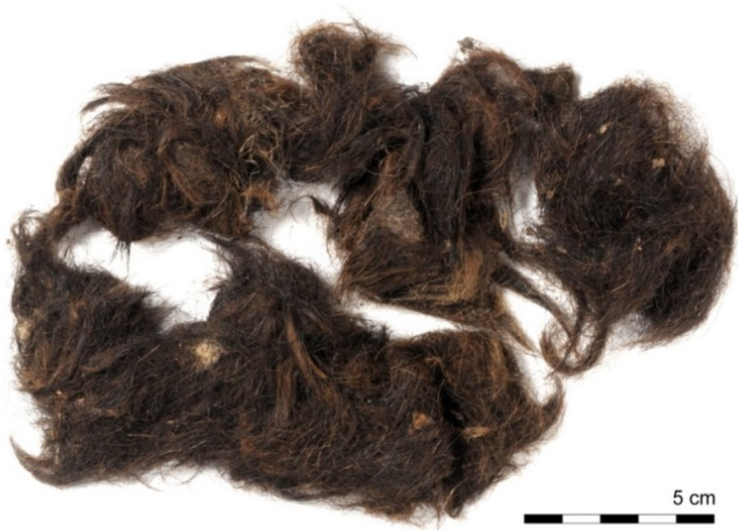
42 Plukken dierlijk haar (VAL1-49-1) dat als 'werk' werd gebruikt om naden tussen scheepsplanken te dichten (te breeuwen)
