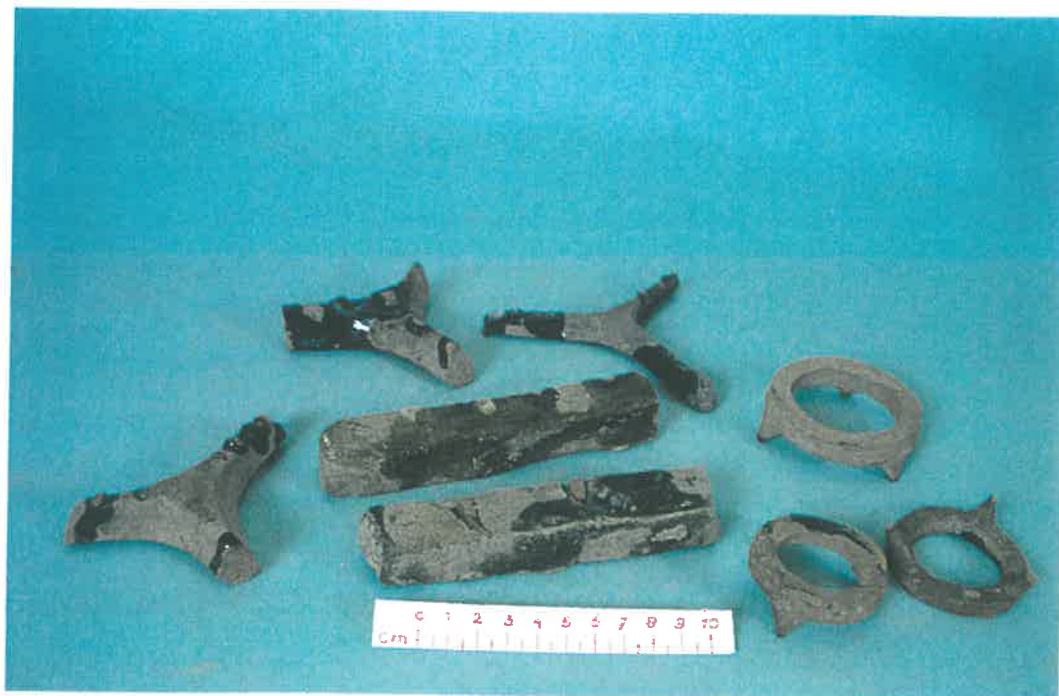
afb. 30 Driepunts-, cirkel- en staafproenen/ Dreipunkt-, kreis- und stabförmige Brennhilfen.
