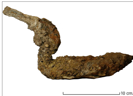
Afb. 21 Smeedijzeren troffel met aangekoekte kalkmortel en resten van een houten handvat, Nederlandsen, ca. 1600.
